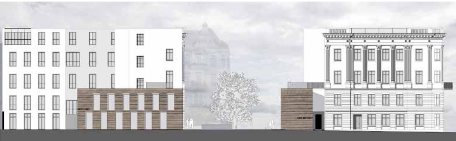
Die ehemalige Fassadengliederung des Altbaus wird im zweigeschossigen Neubau in der horizontalen Ebene aufgenommen. Hier werden die Bossen jedoch durch Holzbohlen gebildet.
