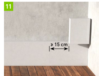
Erste Reihe waagrecht ausrichten. Stoß- und Lagerfuge werden nicht verklebt. Überbindemaß von 15 cm berücksichtigen.
