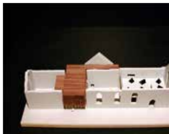
In einen Aufbruch der nördlichen Außenwand der Ruine wird ein zweigeschossiger Gebäuderiegel eingeschoben und mit einem querlaufenden Appendix an die historische Bausubstanz angehängt.
