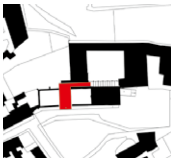
In einen Aufbruch der nördlichen Außenwand der Ruine wird ein zweigeschossiger Gebäuderiegel eingeschoben und mit einem querlaufenden Appendix an die historische Bausubstanz angehängt.
